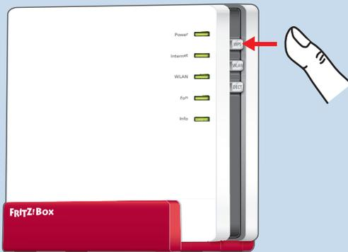
Die Leuchtdiode „WLAN“ an der FRITZ!Box blinkt und die WLAN-Verbindung wird hergestellt.
