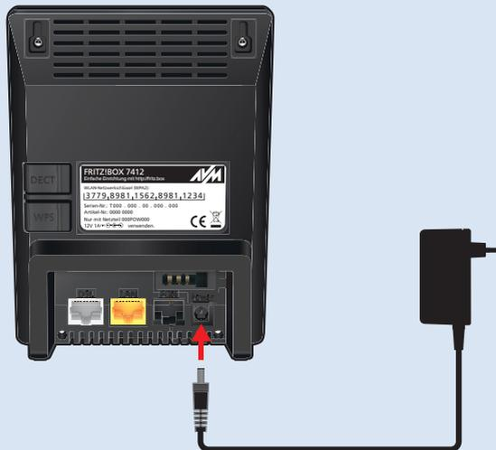
3. Stecken Sie das Netzteil in eine Steckdose der Stromversorgung.
