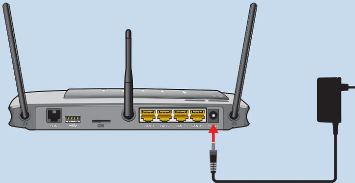
3. Stecken Sie das Netzteil in eine Steckdose der Stromversorgung. Die Leuchtdiode „Power / LTE“ beginnt nach einigen Sekunden zu blinken und signalisiert damit die Betriebsbereitschaft der FRITZ!Box.
