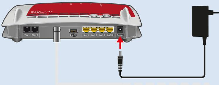
3. Stecken Sie das Netzteil in eine Steckdose.
