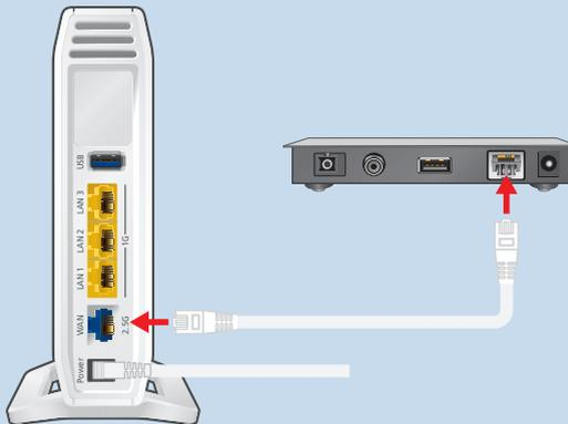
2. Stecken Sie das andere Ende des Netzwerkkabels in die LAN-Buchse (Ethernet-Buchse) am DSL-Modem.
