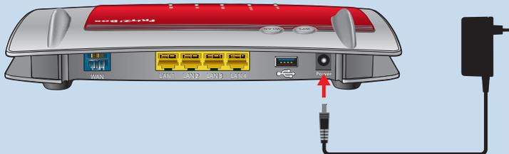
2. Stecken Sie das Netzteil in eine Steckdose.
