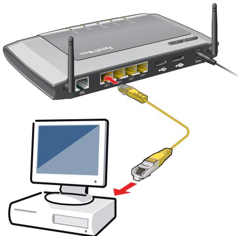
Anschluss eines Computers mit einem Netzwerkkabel
