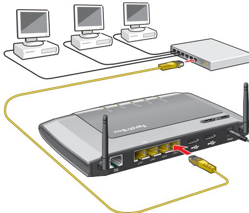
1. Stecken Sie das mitgelieferte Netzwerk-Kabel in den Uplink-Port des Netzwerk-Hubs oder Netzwerk-Switches.
